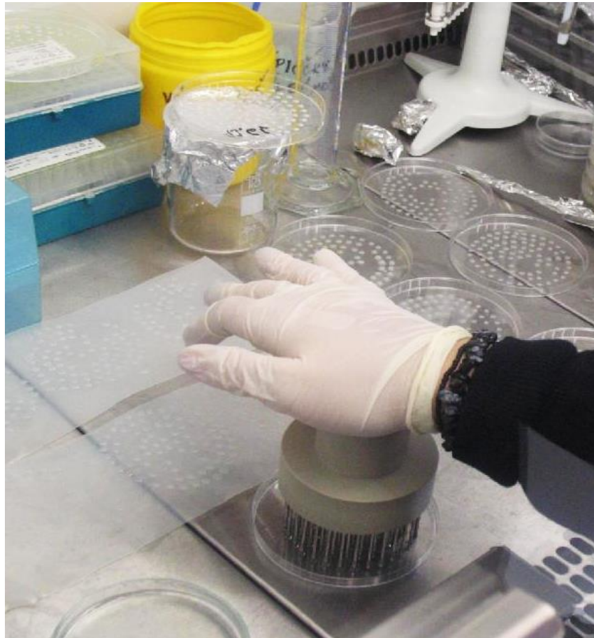
Obr. 13: Hlava pro tvoření čoček Lentikats ®
