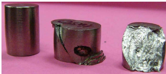
Obr. 28 Zkušební vzorek po provedení speciální pěchovací zkoušky [31]
