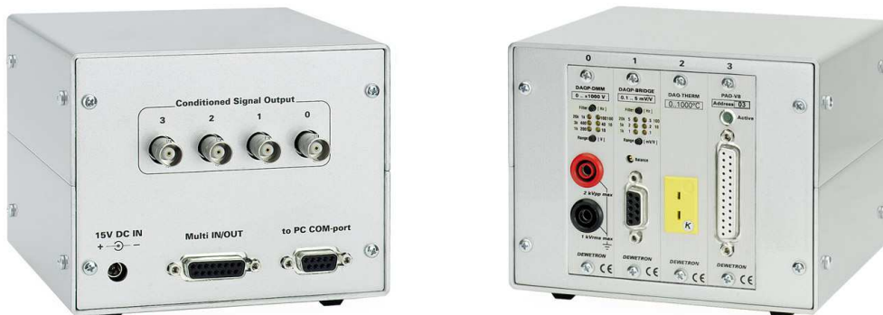
Obr. 38 Modul pro úpravu signálu DEWE-30-4 [5]
