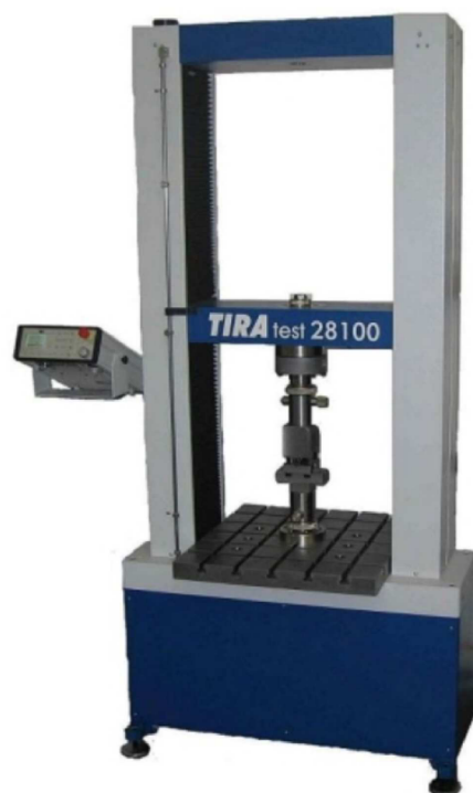
Obr. 34 Univerzální zkušební stroj TIRAtest 28100 [30]
