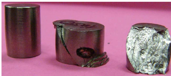
Obr. 28 Zkušební vzorek po provedení speciální pěchovací zkoušky [31]
