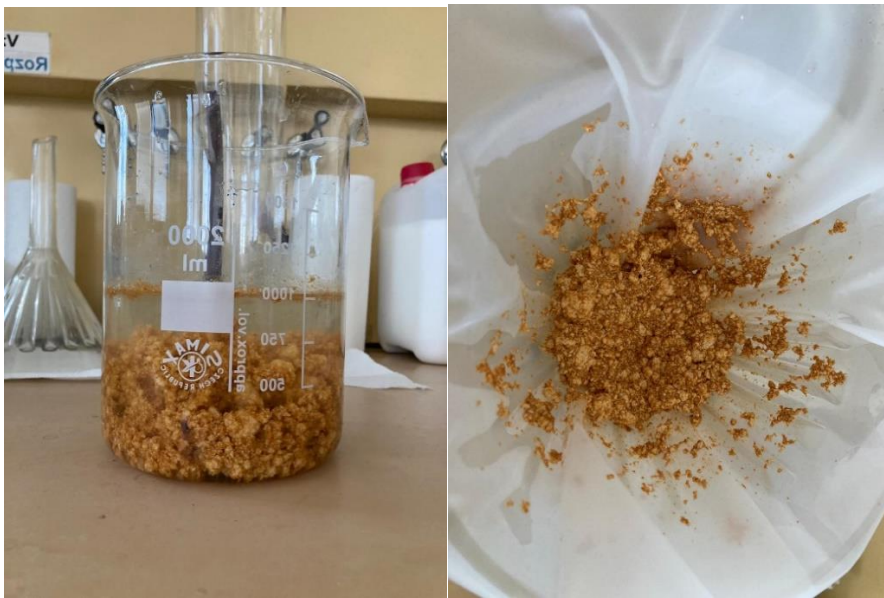
Obrázek 13: Přídavek flokulantu a následná filtrace přes uhelon
