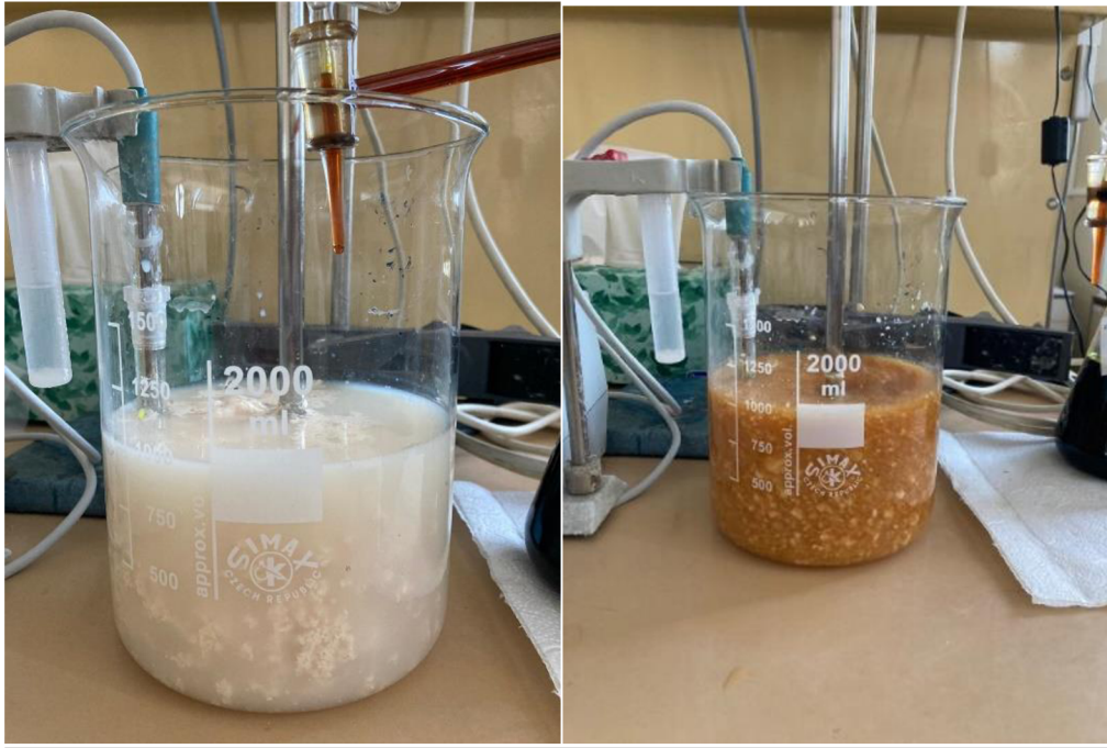
Obrázek 12: Přídavek koagulačního činidla a vápenného mléka
