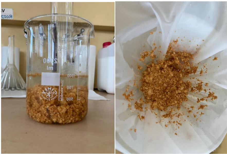
Obrázek 13: Přídavek flokulantu a následná filtrace přes uhelon
