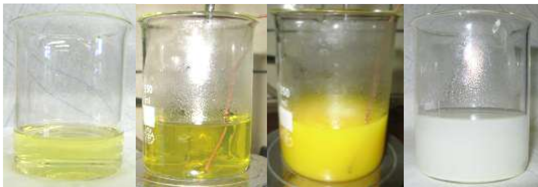
Obr. č. 10. Postupný barevný přechod roztoků sulfidových louhů při titraci ředěným peroxidem vodíku (foto: Kundertová N.)
