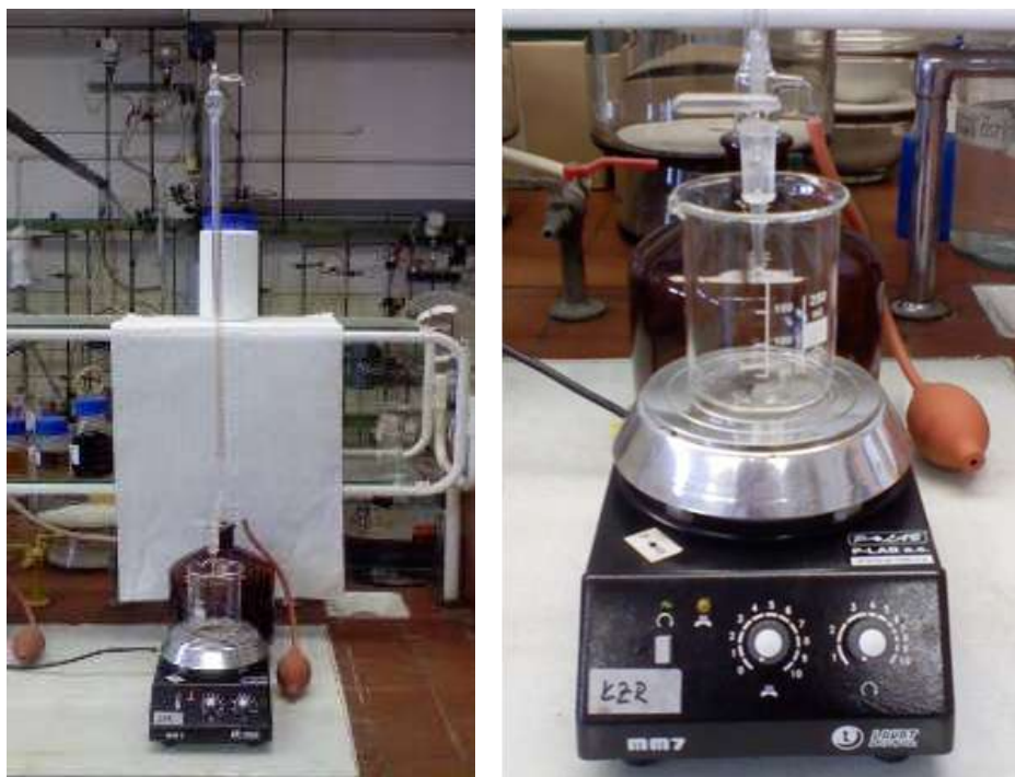
Obr. č. 9. Pokusná aparatura na oxidaci sulfidových louhů peroxidem vodíku (foto: Kundertová N.)
