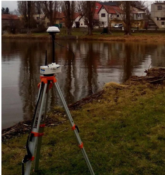
Obrázek 10: RTK stanice na břehu nádrže (zdroj: Anežka Nevoralová, zatím nepublikováno)
