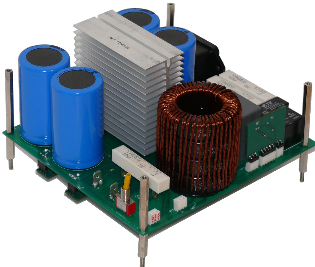
Obr. 5-5 Osazený modul APFC pohled shora.
