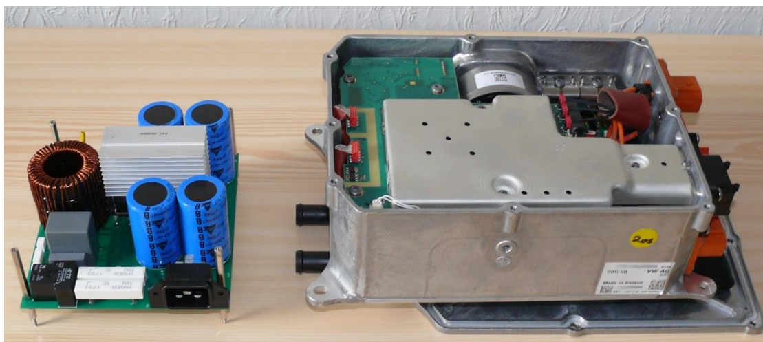
Obr. 2-6 Palubní nabíječka 3,6 kW pro vozy VW a realizovaný PFC modul
