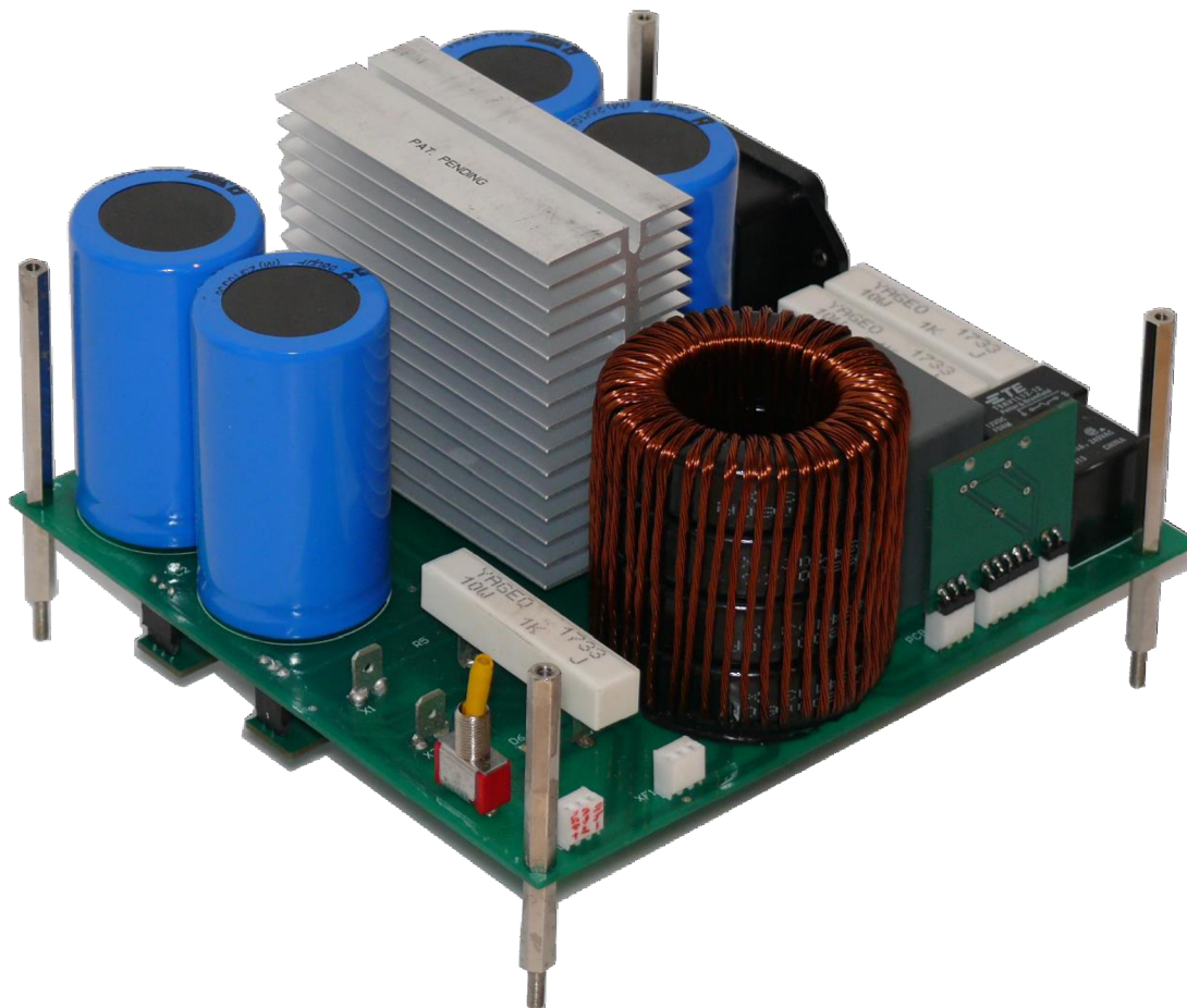
Obr. 5-5 Osazený modul APFC pohled shora.
