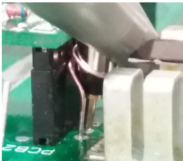
Obr. 5-8 Detail připojení sondy při měření napětí u_{gs}
