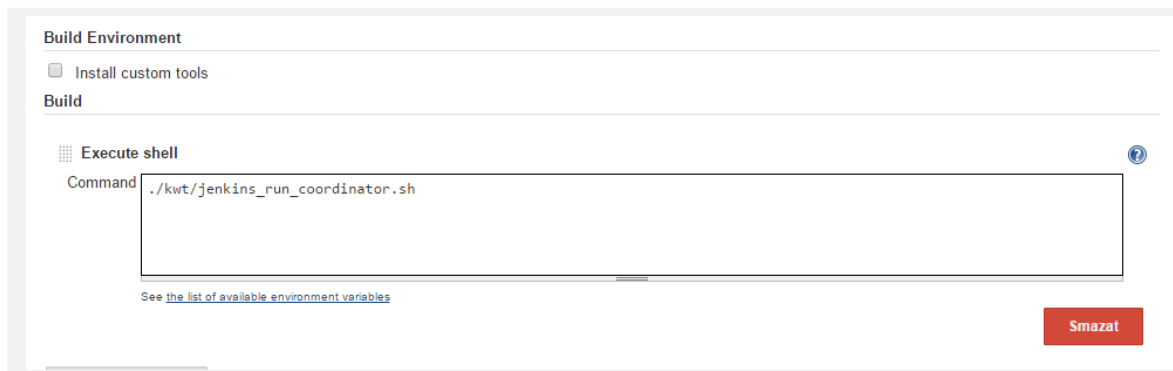
Obrázek 4.8: Jenkins spuštění bash skriptu
