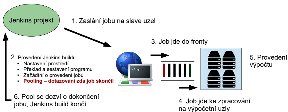
Obrázek 3.5: Sekvenční build s jedním Jenkins projektem
