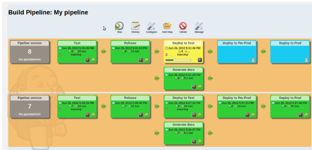
Obrázek 4.14: Jenkins pipeline view
