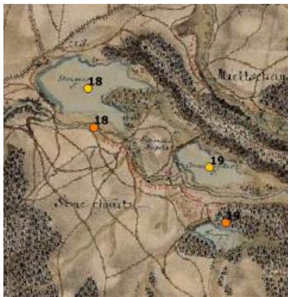
Obr. 8: Posun centroidů vodních ploch I. vojenského mapování (žlutá) a II. vojenského mapování (oranžová), (zdroj: Mapire.eu, zpracováno v QGIS)
