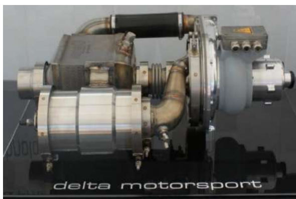
Obr. 2.8 Technologický demonštrátor predlžovača dojazdu MiTRE [65]
