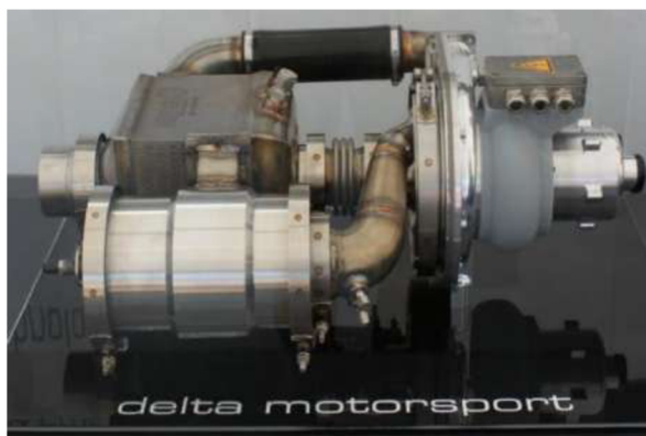
Obr. 2.8 Technologický demonštrátor predlžovača dojazdu MiTRE [65]
