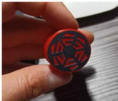
Obrázek 19: Materiálová zkouška: plug z 3D tisku, na něm je nalepená čtvrtka s vyřezaným vzorem I
