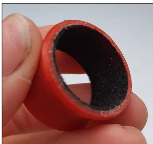
Obrázek 44: Tunel z 3D tisku s flokováním uvnitř
