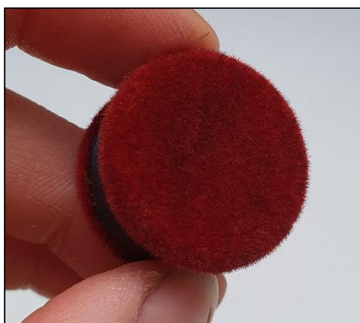
Obrázek 45: Plug z 3D tisku s flokováním na předních stranách
