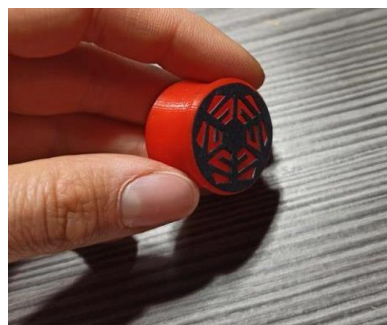
Obrázek 20: Materiálová zkouška: plug z 3D tisku, na něm je nalepená čtvrtka s vyřezaným vzorem II
