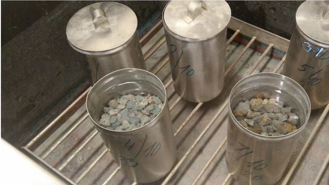
Obrázek 35 - Detailní pohled na vnitřek nádob s viditelnou hladinou 1 cm nad navážkou, vlastní foto
