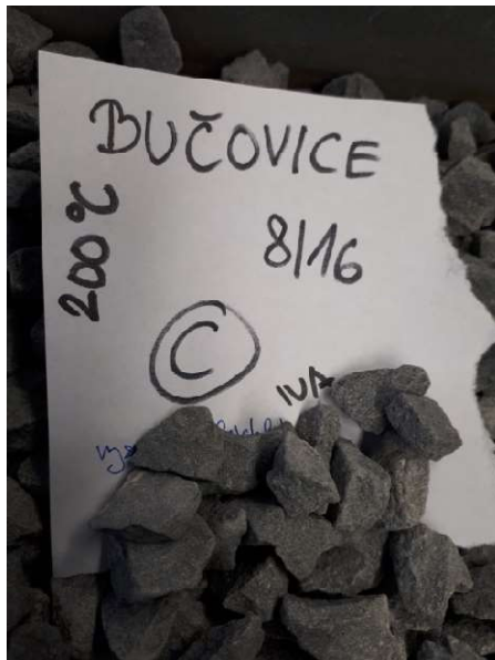
Obrázek 30 - Detail na popisování jednotlivých navážek po rozsítování kameniva, vlastní foto
