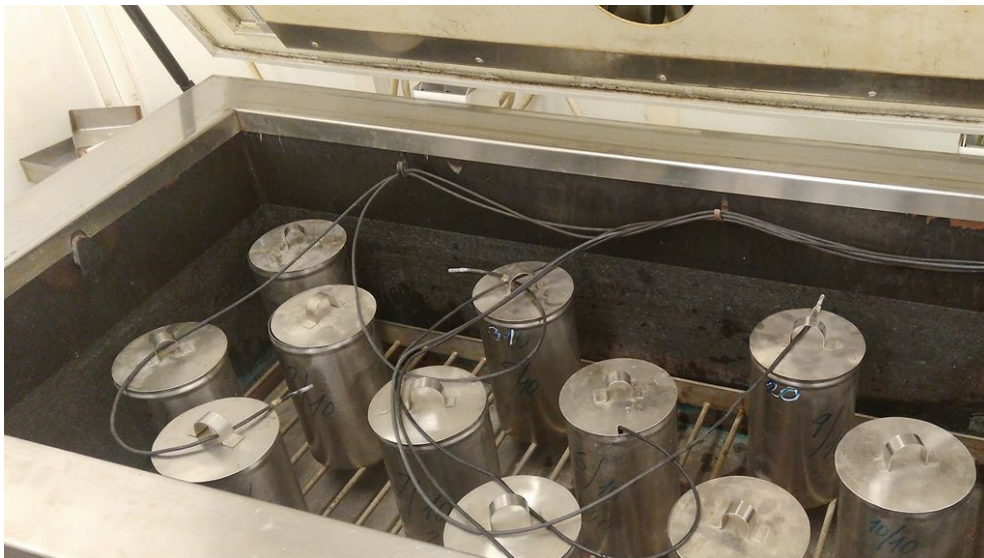
Obrázek 34 - Pohled na vnitřek mrazicího boxu s ocelovými nádobami, vlastní foto
