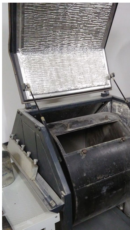
Obrázek 32 - Pohled na dutý buben a detail olověných koulí, vlastní foto
