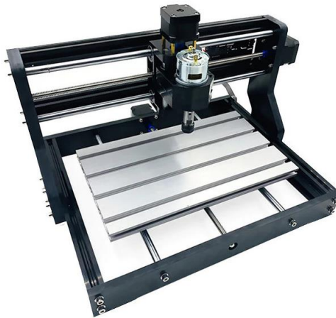
Obrázek 8 Portálová konstrukce s pevným rámem
