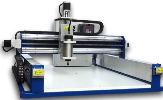
Obrázek 7 Portálová konstrukce s pohyblivým rámem
