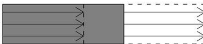
OBR. 2.2.1.2: Neúplné určení optického toku
