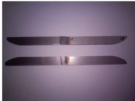
Obr. 50 Vzorky pro test solnou mlhou
