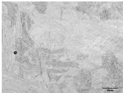
Obr. 61 Martenzitická struktura vzorku 1
