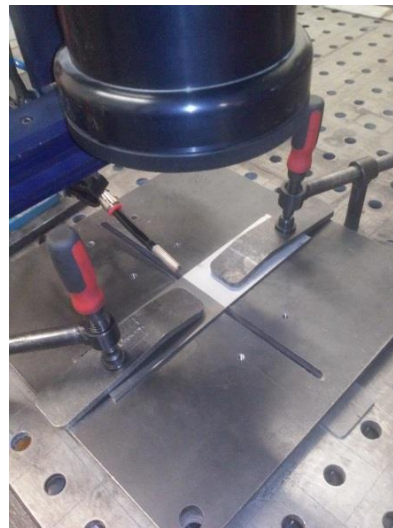
Obr. 44 Upnutí svařovaných vzorků
