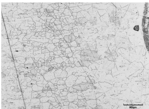
Obr. 63 Tepelně ovlivněná oblast X6Cr17
