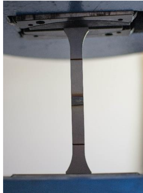
Obr. 78 Upnutí vzorku do trhacího stroje
