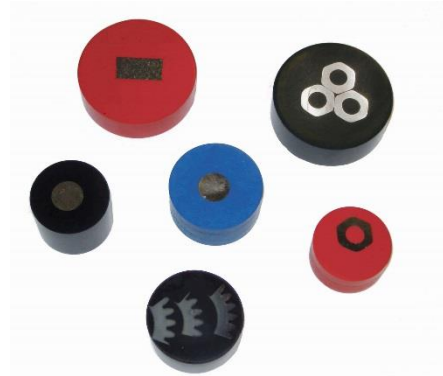
Obr. 32 Vzorky pro metalografii [73]
