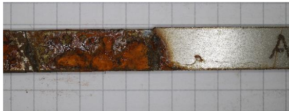
Obr. 84 Koroze na vzorku A
