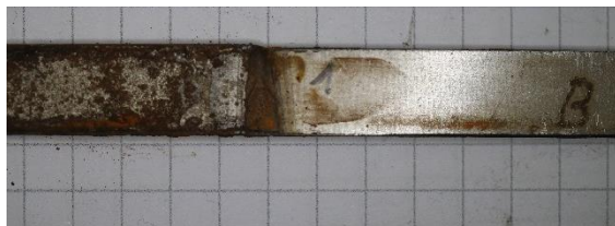
Obr. 85 Koroze na vzorku B
