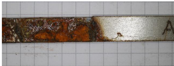
Obr. 84 Koroze na vzorku A
