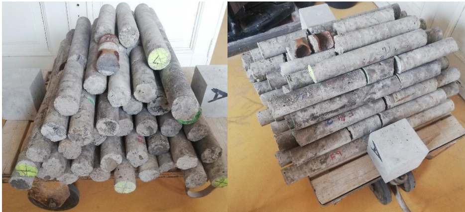
Obrázek 5: Hromadné foto vývrtů po dovozu do laboratoře [Q]
