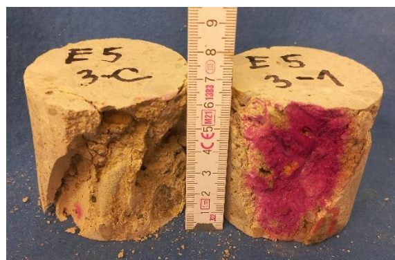
Obrázek 29: Dvojice těles z vývrtu E5 – 3 vybraných pro ověření karbonatace
