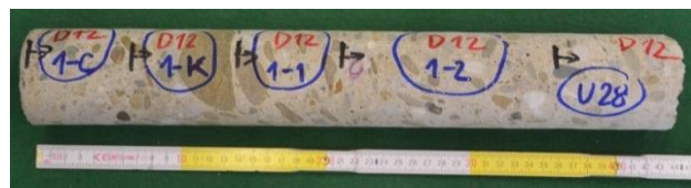
Obrázek 15: Vyznačená tělesa na vývrtech ze sloupu D12 – 1
