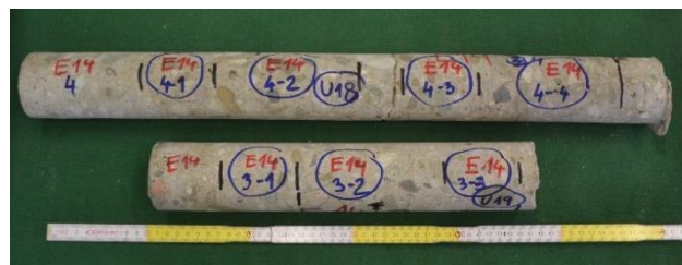
Obrázek 14: Naznačená tělesa na vývrtech ze sloupu E14
