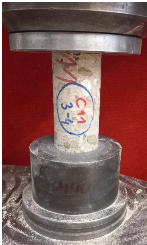
Obrázek 20: Zkušební těleso C11 3-4 před zkouškou v lisu
