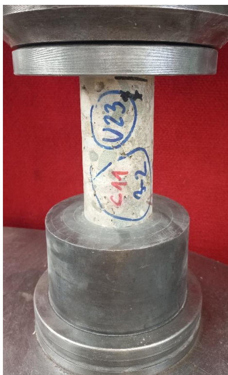
Obrázek 22: Zkušební těleso C11 3-2 před zkouškou v lisu
