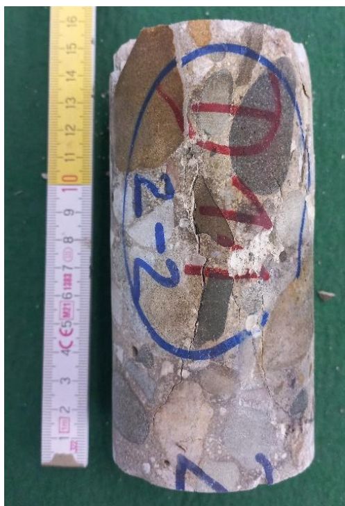
Obrázek 24: Zkušební těleso D11 2-2 s viditelnými velkými zrny kameniva
