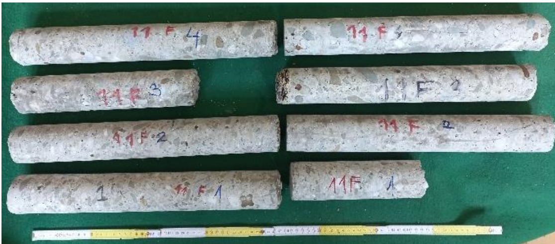
Obrázek 10: Vývrtý ze sloupu F11
