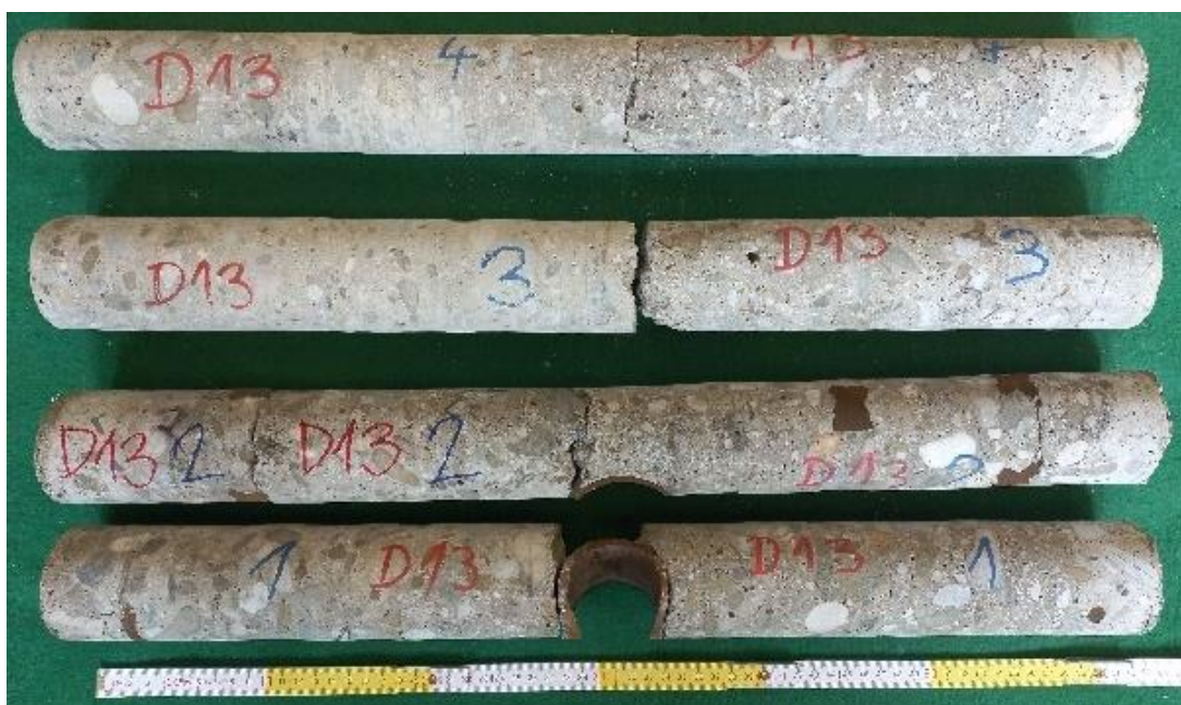
Obrázek 55: Fotodokumentace vývrtů ze sloupu D13
