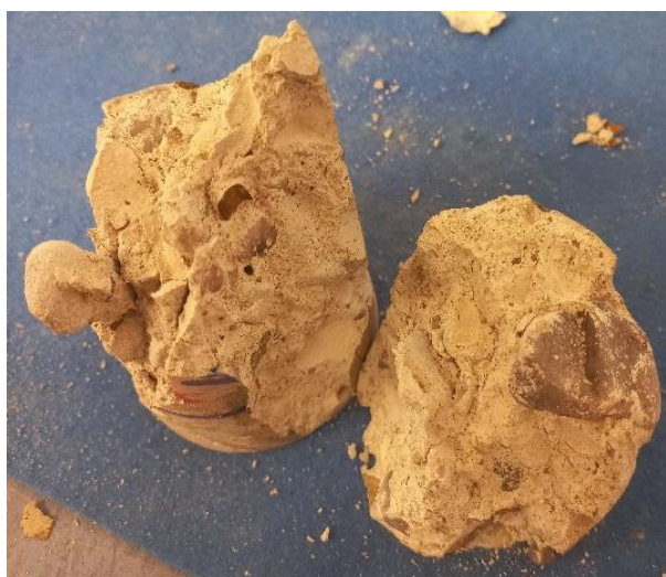
Obrázek 27: Zkušební těleso D11 4-4 s velkými zrny kameniva nalezenými po provedení zkoušky
