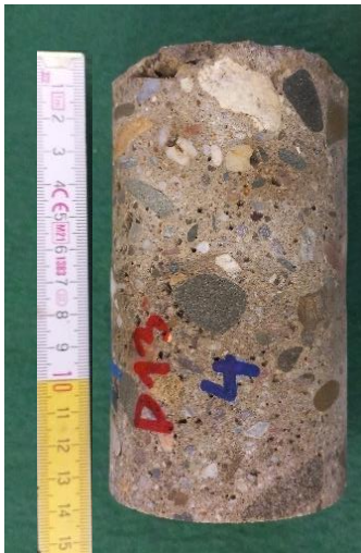
Obrázek 17: Vzorok vizuálně zkarbonatovaný
