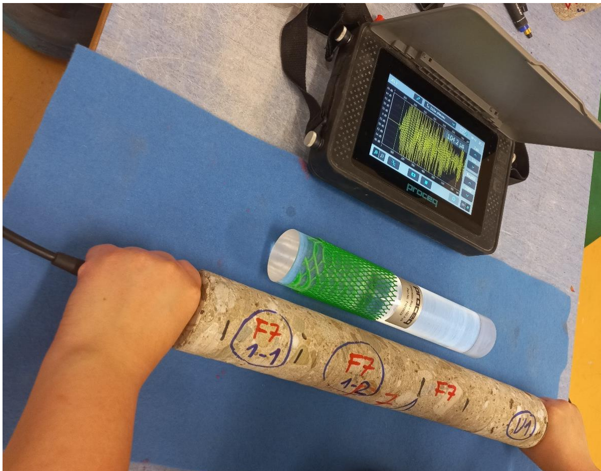
Obrázek 11: Průběh ultrazvukového měření na vývrtu F7-1 (U1)
