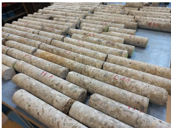
Obrázek 8: Souhrnné foto vývrtů
