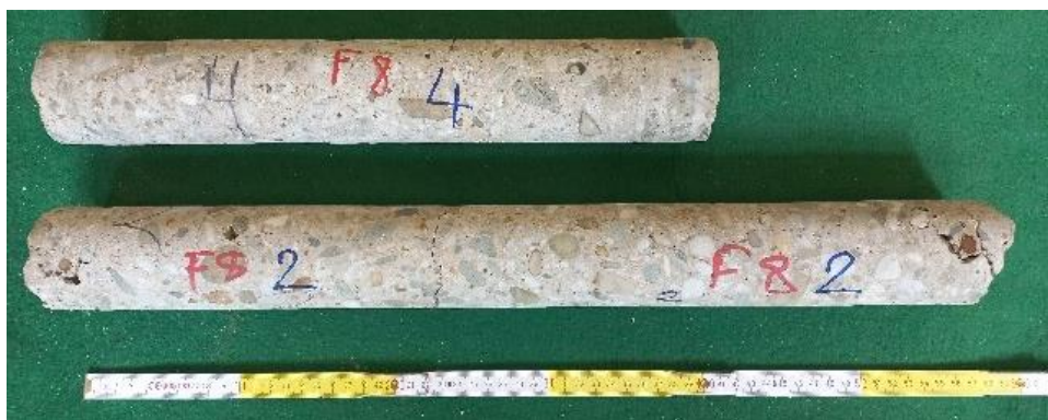
Obrázek 61: Fotodokumentace vývrtů ze sloupu F8
