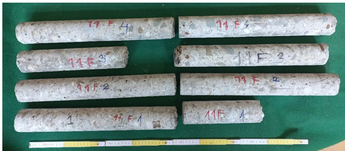
Obrázek 10: Vývrty ze sloupu F11
