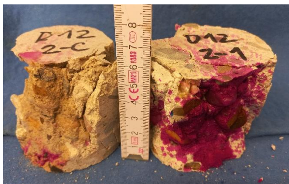
Obrázek 28: Dvojice těles z vývrtu D12 – 2 vybraných pro ověření karbonatace
