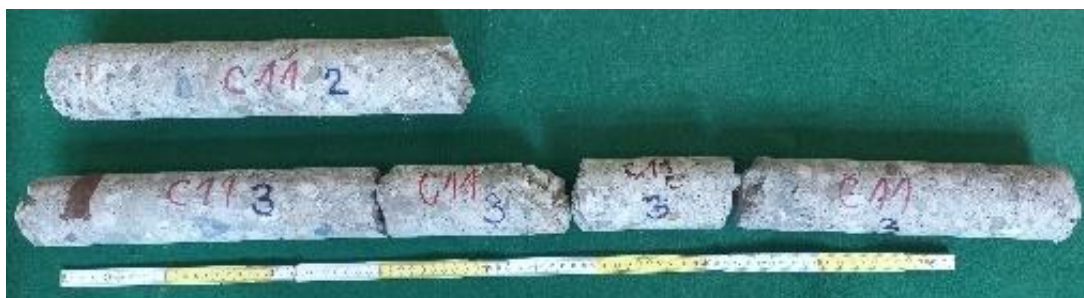
Obrázek 52: Fotodokumentace vývrtů ze sloupu C11
