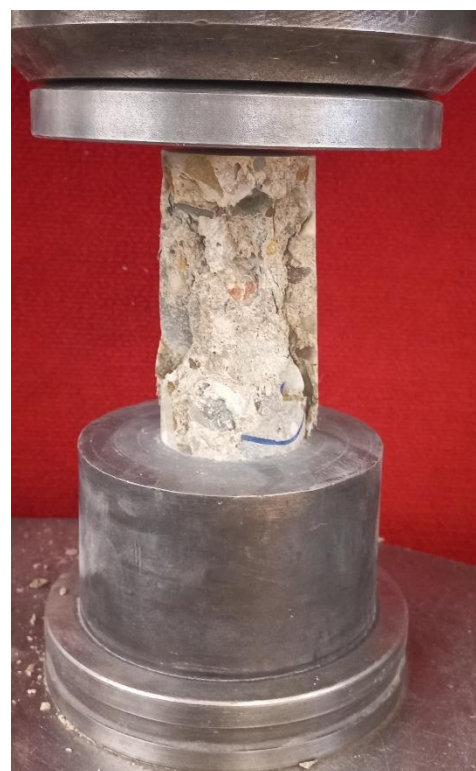
Obrázek 23: Zkušební těleso C11 3-2 po provedení zkoušky
