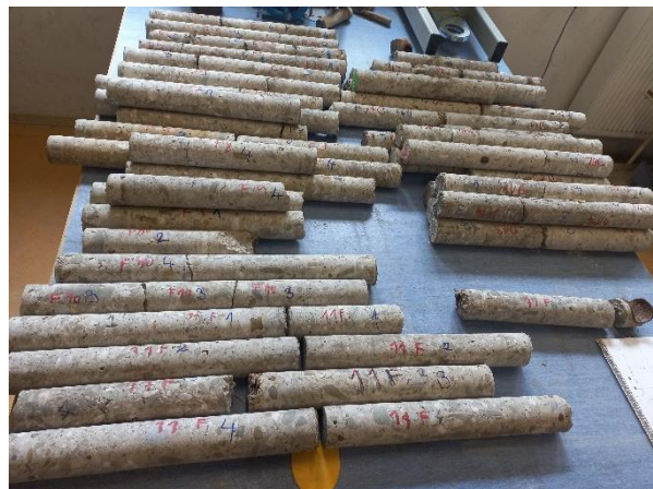
Obrázek 9: Vývrty po prvotním vizuálním zhodnocení
