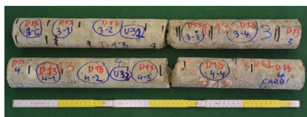
Obrázek 16: Vyznačená tělesa na vývrtech ze sloupu D13
