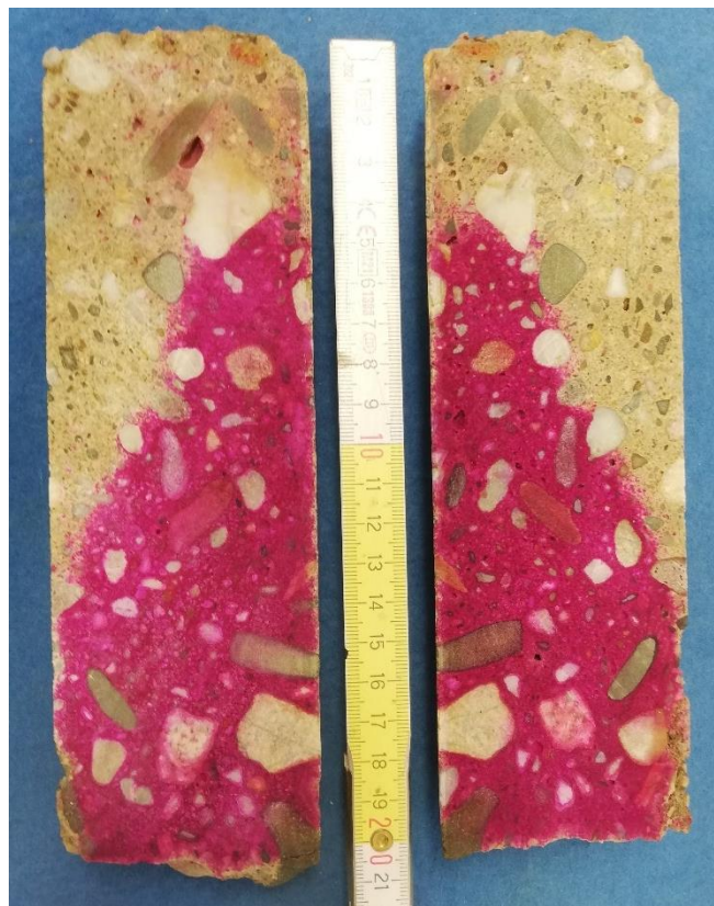
Obrázek 36: Vývrt D14 – 3 po řezu a nanesení fenolftaleinu prokazujícího šikmou karbonataci
