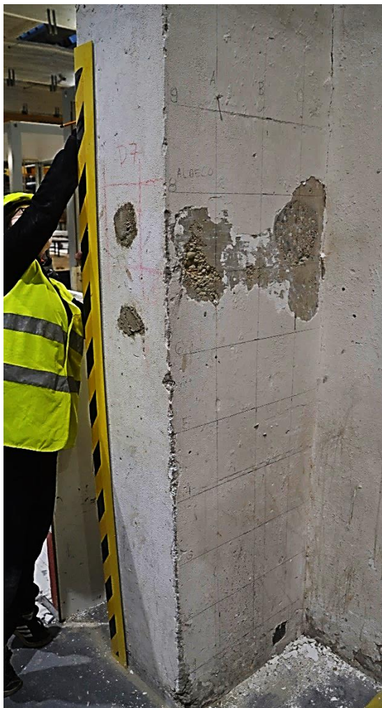
Obrázek 45: Příprava rastru pro ultrazukové proměření sloupu D7 [20]
