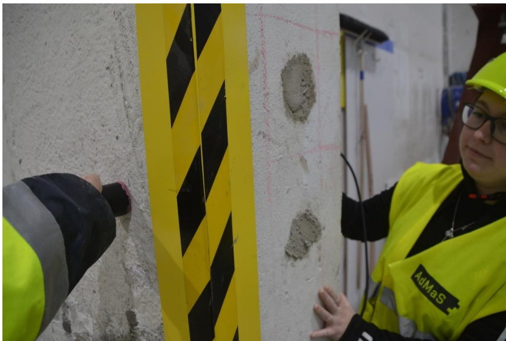
Obrázek 44: Ultrazvukové měření sloupu D7 [20]
