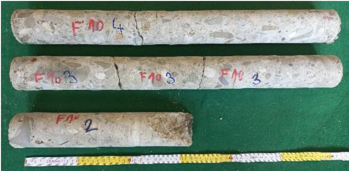
Obrázek 63: Fotodokumentace vývrtů ze sloupu F10
