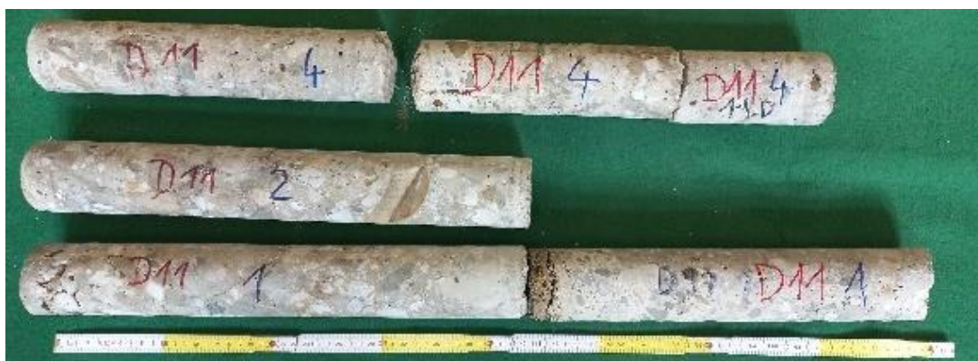
Obrázek 53: Fotodokumentace vývrtů ze sloupu D11
