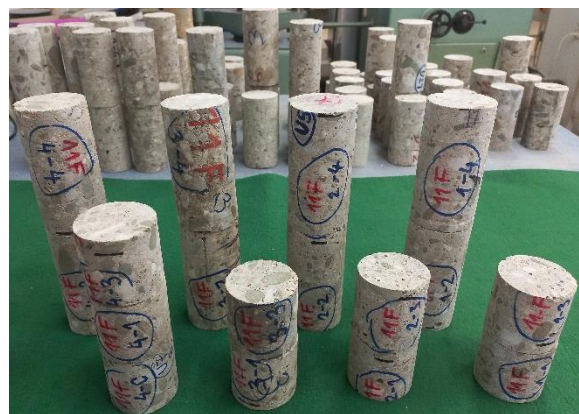
Obrázek 7: Tělesa 1:1 a 2:1 ze sloupu F11
