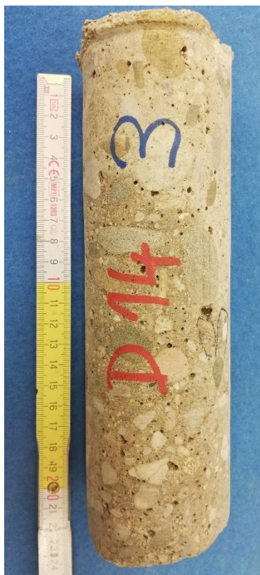
Obrázek 35: Vývrt D14 – 3 před řezem, lehce viditelná karbonatace
