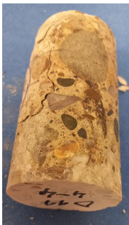
Obrázek 25: Zkušební těleso D11 4-4 s viditelnými velkými zrny kameniva
