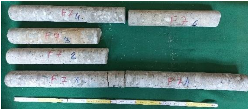
Obrázek 60: Fotodokumentace vývrtů ze sloupu F7
