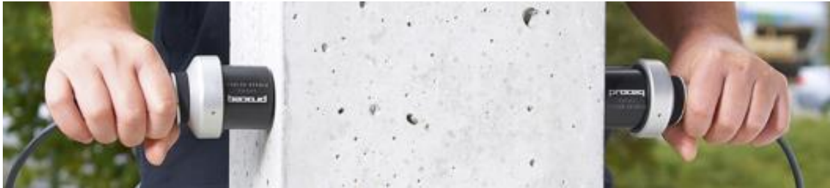
Obrázek 1: Ukázka přímého prozvučování prvku [19]
