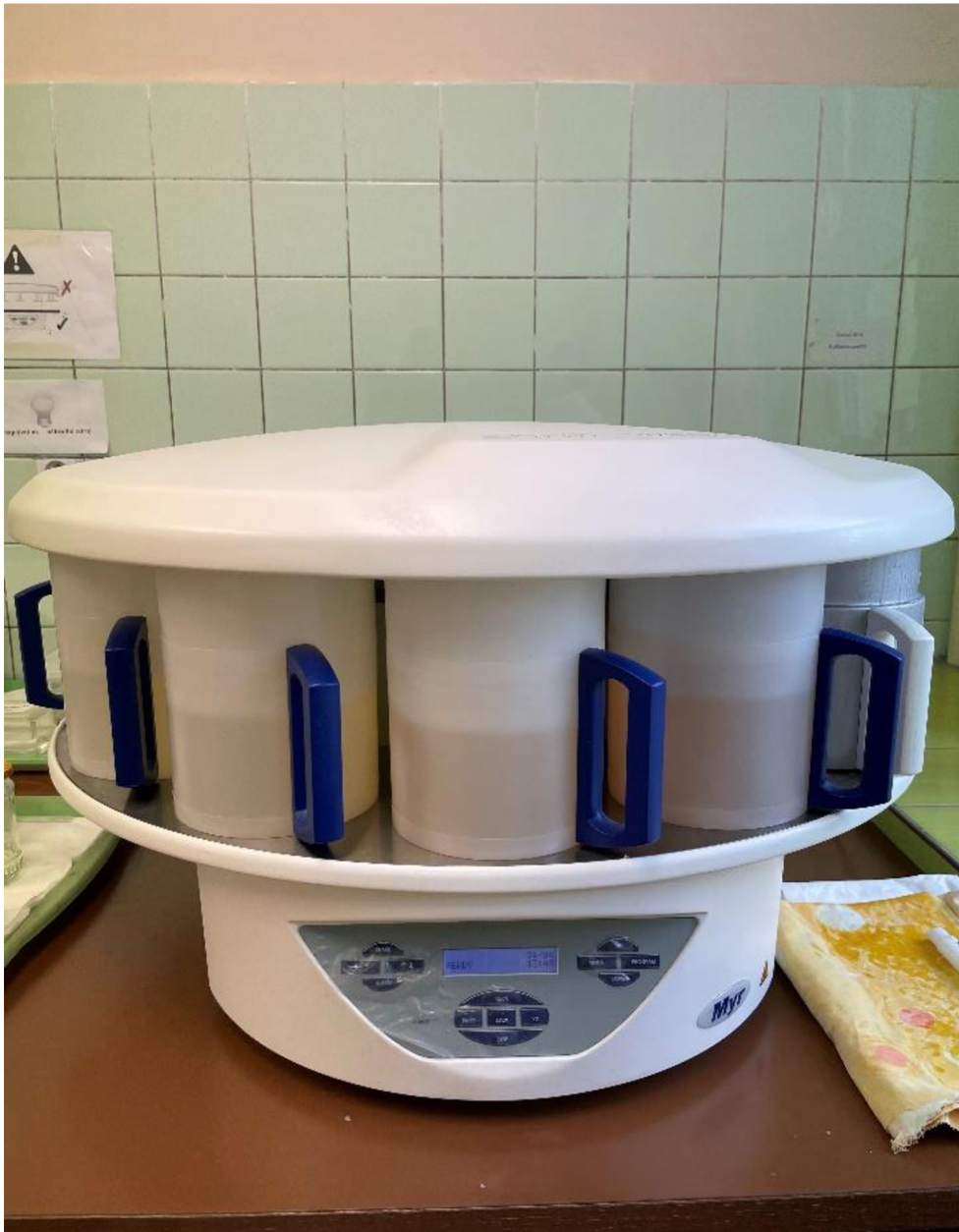
Obrázek 10. Odvodňovací automat – STP 120. (Zdroj: vlastní fotografie).
