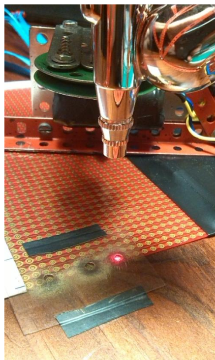
Obr. 29 Ukázka pokusu nanášení vodivého inkoustu na povrch elektrod skrz šablonu
