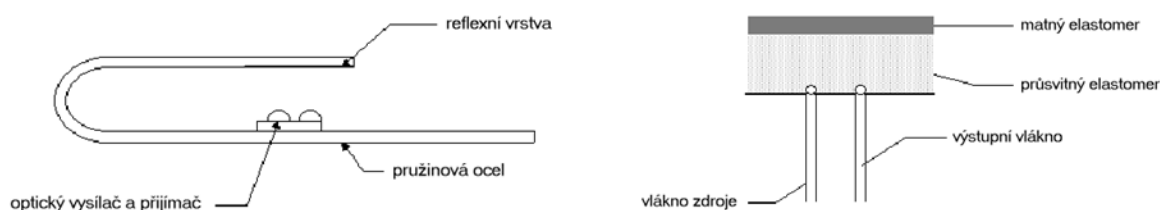
Obr. 15 Vlevo optický senzor s pružným členem, vpravo senzor s průsvitným elastomerem
