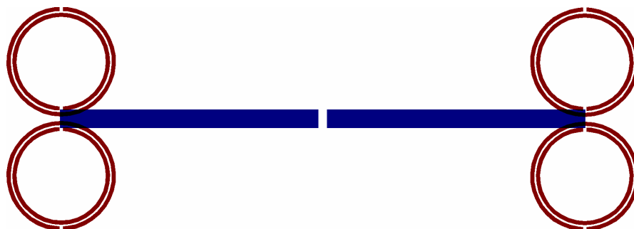
Obr. 5.2.2.3. Struktura antény pro nejbližší frekvenční pásma pomocí dvojice rezonančních kroužků
