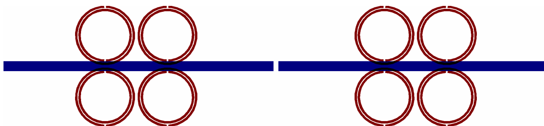
Obr. 5.2.1.1. Struktura antény pro nejvzdálenější frekvenční pásma
