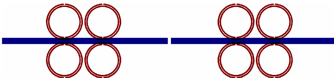
Obr. 5.2.1.1. Struktura antény pro nejvzdálenější frekvenční pásma
