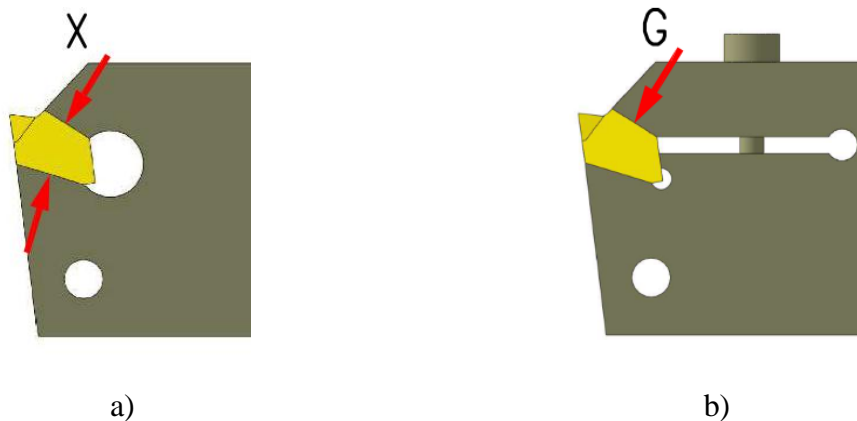
Obr. 2.3 Typy upnutí VBD v držáku a) ISO X, b) ISO G.
