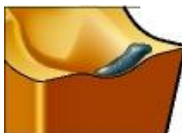
Obr. 3.4 Opotřebení ve tvaru žlábků u VBD pro zapichování [11].
