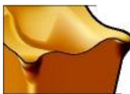
Obr. 3.6 Plastická deformace břitu u VBD pro zapichování [11].
