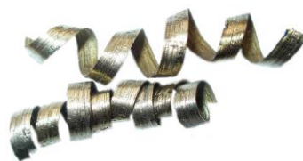
Obr. 4.37 Tvar a barva třísky při opotřebení na hřbetě VB = 1,13 mm
