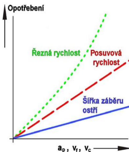
Obr. 3.2 Vliv řezných podmínek na opotřebení [4].
