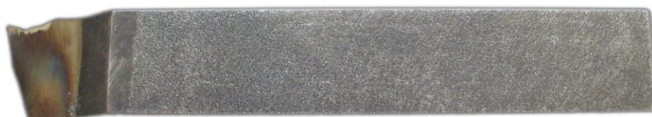
Obr. 4.17 Celistvý zapichovací nůž 20x12 35510 z rychlořezné oceli 19 860.
