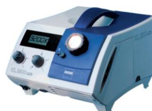
Obr. 4.21 a) Stereomikroskop STEMI 2000-C, b) zdroj studeného světla KL 1500 LCD [1].
