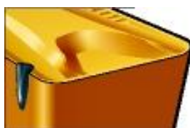
Obr. 3.7 Vrubové opotřebení u VBD pro zapichování [11].
