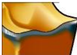
Obr. 3.3 Opotřebení hřbetu u VBD pro zapichování [11].
