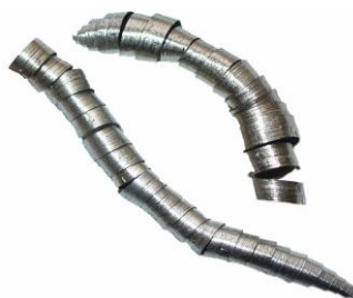
Obr. 4.36 Tvar a barva třísky u nového nástroje VB = 0,00 mm
