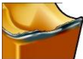
Obr. 3.8 Nárůstek na břitu u VBD pro zapichování [11].
