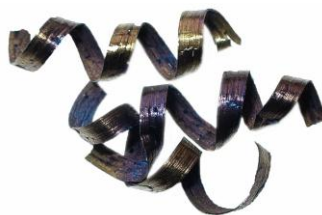
Obr. 4.38 Tvar a barva třísky při opotřebení na hřbetě VB = 3,28 mm
