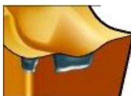
Obr. 3.5 Vydrolené ostří u VBD pro zapichování [11].
