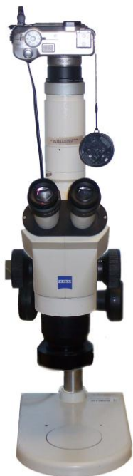
Obr. 4.21 a) Stereomikroskop STEMI 2000-C, b) zdroj studeného světla KL 1500 LCD [1].
