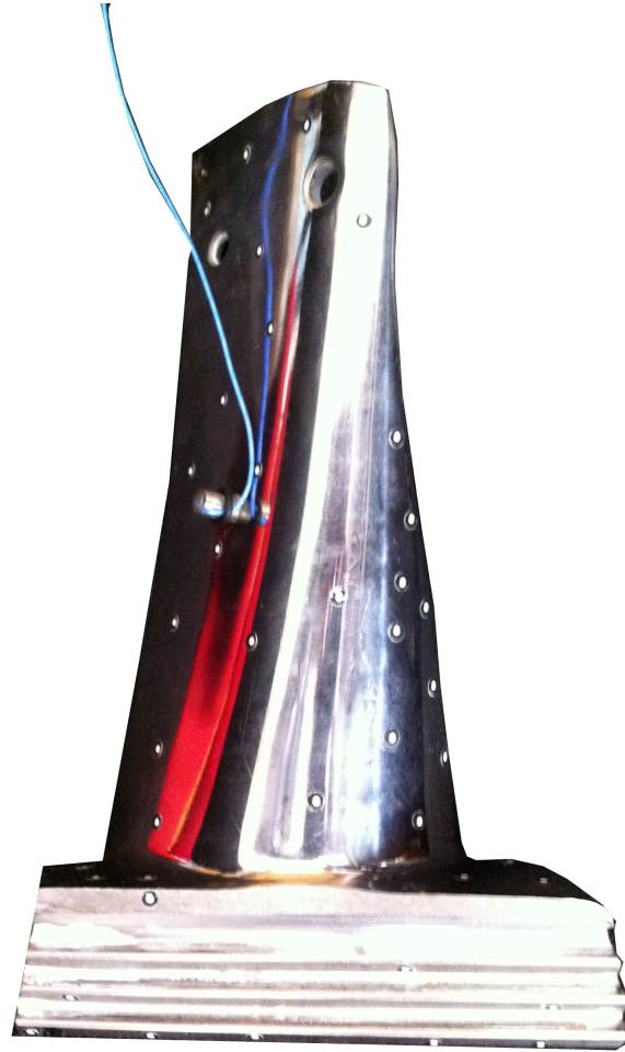
Obrázek 6.3: Umístění akcelerometru na lopatce
