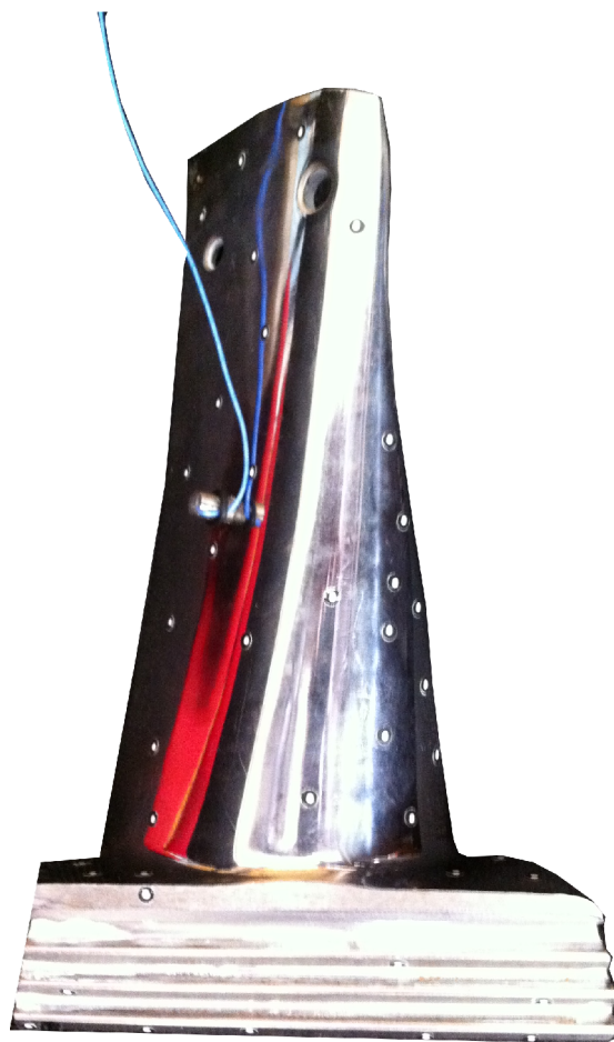
Obrázek 6.3: Umístění akcelerometru na lopatce
