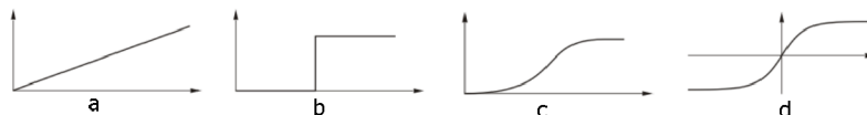
Obrázek 4.3: Aktivační funkce neuronu: a) lineární, b) skoková, c) sigmoida, d) hyperbolický tangenc
