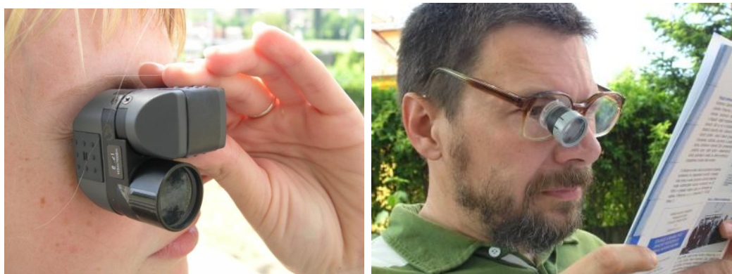
Obrázek 8: Monokulár, Galileiho systém
