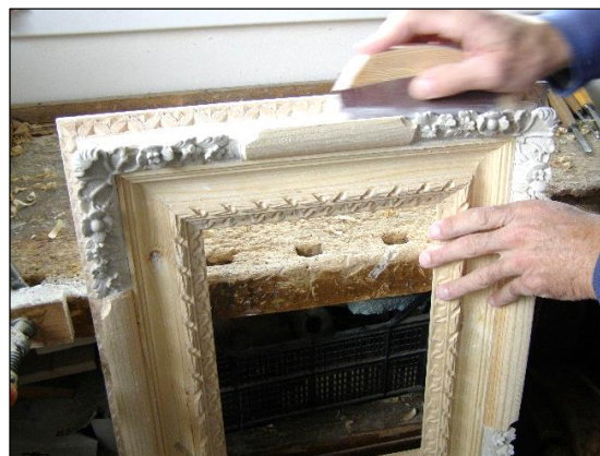
Obr. 40 - Broušení povrchu rámu před povrchovou úpravou
