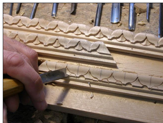
Obr. 36 - Vyřezávání vnějších ornamentů
