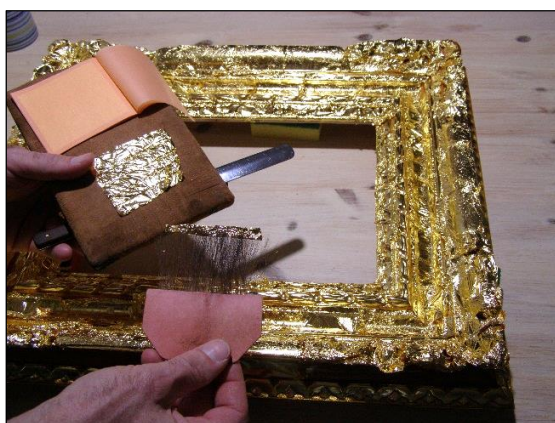
Obr. 47 - Pozlacování technikou na mat
