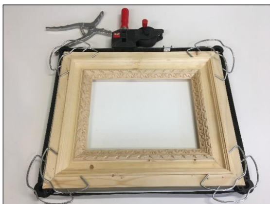
Obr. 35 - Lepení základu rámu
