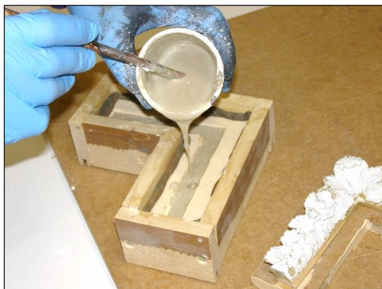
Obr. 37 - Odlévání ozdobných rohových ornamentů
