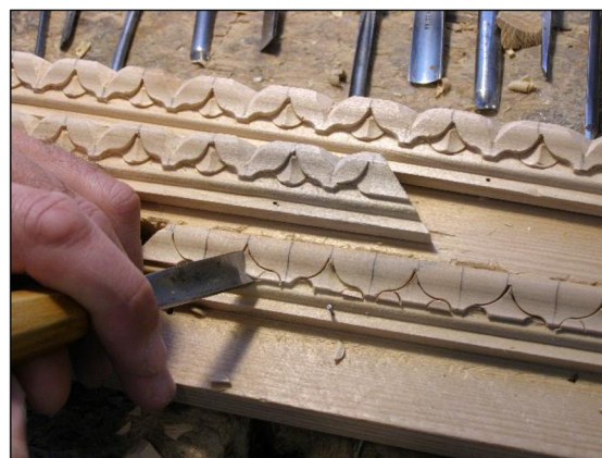
Obr. 36 - Vyřezávání vnějších ornamentů
