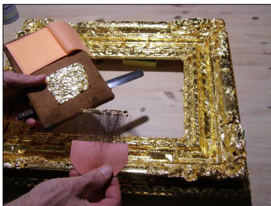
Obr. 47 - Pozlacování technikou na mat
