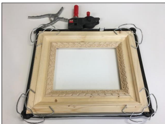
Obr. 35 - Lepení základu rámu
