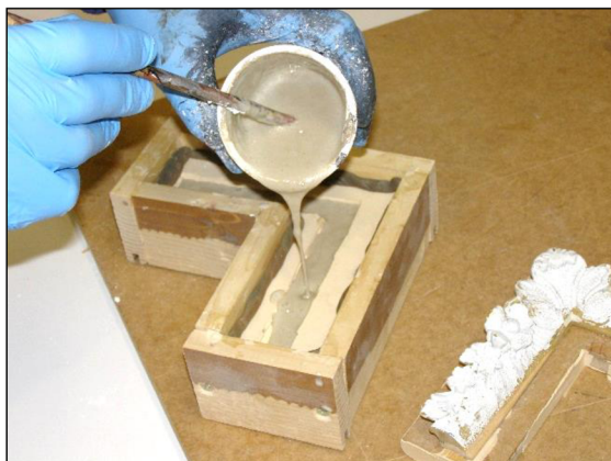
Obr. 37 - Odlévání ozdobných rohových ornamentů
