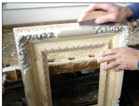
Obr. 40 - Broušení povrchu rámu před povrchovou úpravou
