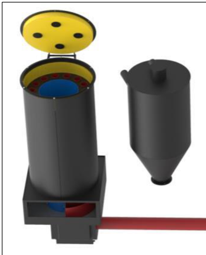
Obr. 14 - První koncepce kotle na pelety
