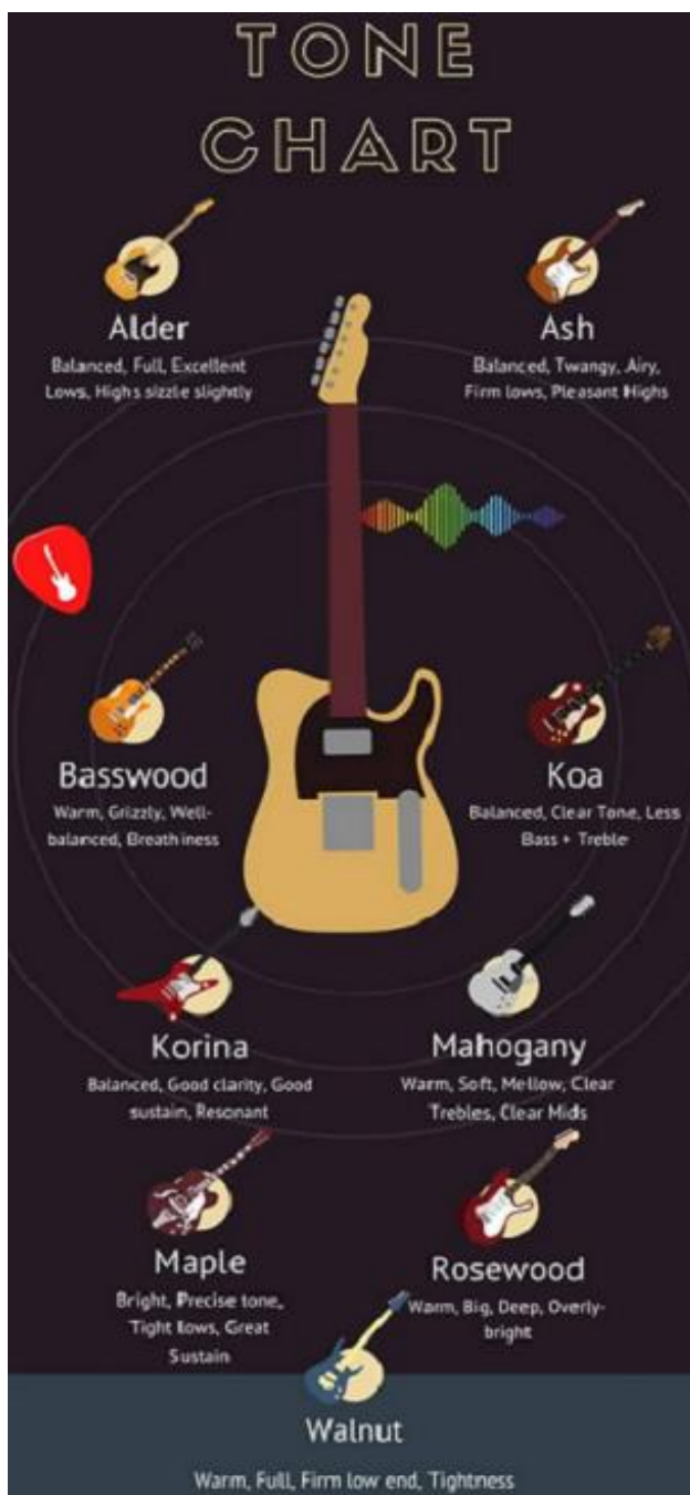
Obr. 15 Vliv různých druhů dřeva na výsledný zvuk elektrické kytary (Nusselder, 2021)
