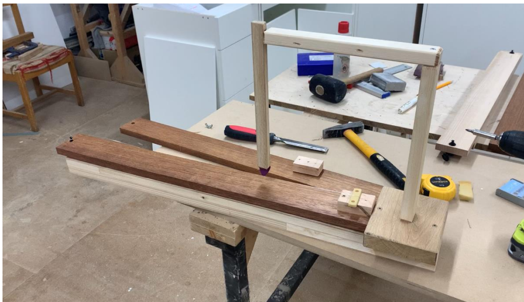
Obr. 18 Vyrobené kyvadlo pro zajištění stejných podmínek rozvibrování (autor)
