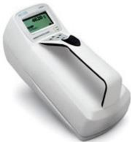
Obrázek 5: Kondenzační čítač částic [30]
