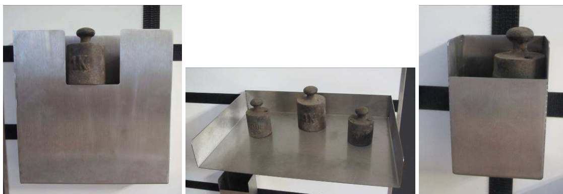
Obr. 54 – Zkouška nosnosti závěsných prvků
