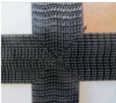
Obr. 42 – Detail spojení suchého zipu Dual Lock
