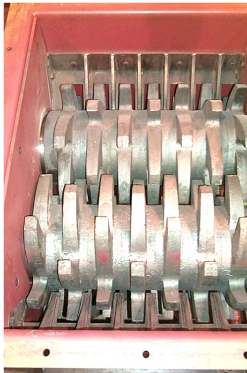
Obr. 1.12 Drtič s ozubenými válci [15]
