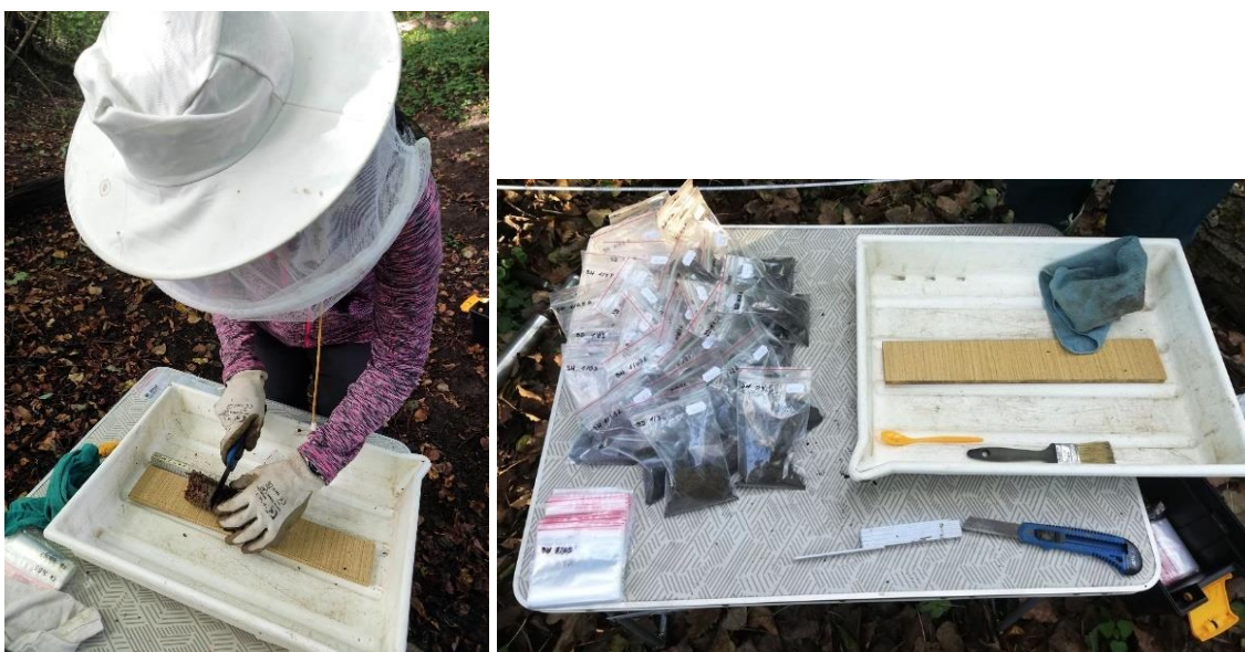
Příloha 2. Odběr vrchních 0–3 cm ze vzorku sedimentu pomocí odlamovacího nože a jejich ukložení do připravených PVC sáčků. (© Lucie Fišarová)
