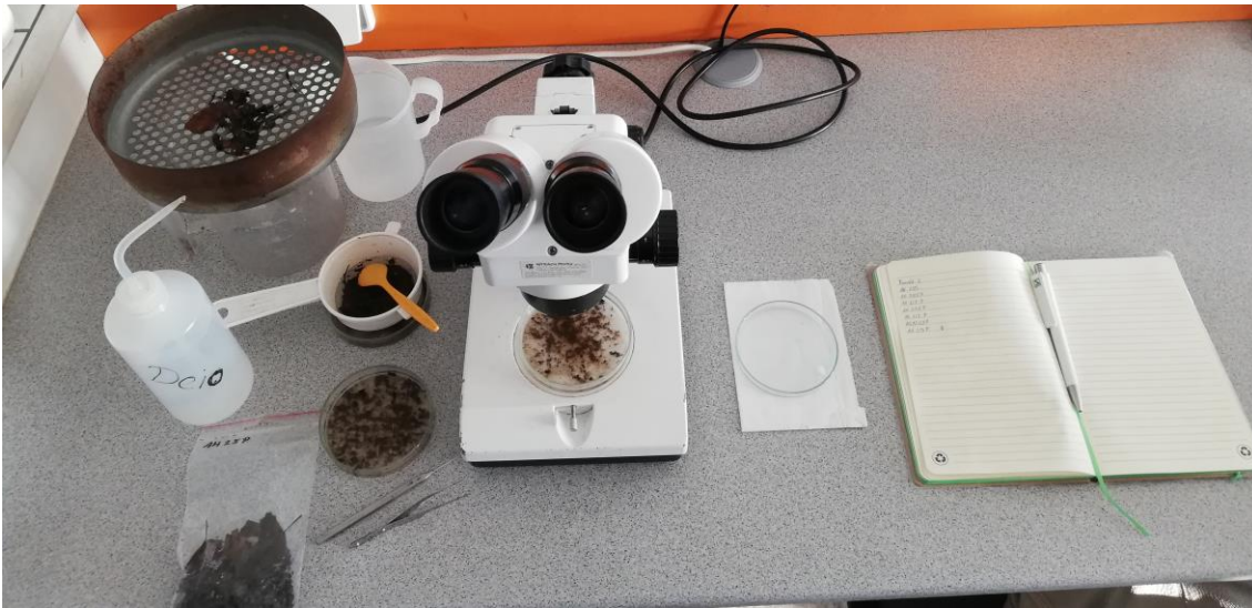
Příloha 3. Zpracování vzorků v laboratoři rozplavením sedimentů destilovanou vodou v Petriho misce s využitím stereomikroskopu (© Lucie Fišarová)
