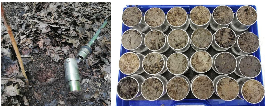
Obrázek 9. Kopeckého válečky pro odběr vzorků na stanovení vlhkosti půdy a koncentrace TOC (© Lucie Fišarová)
