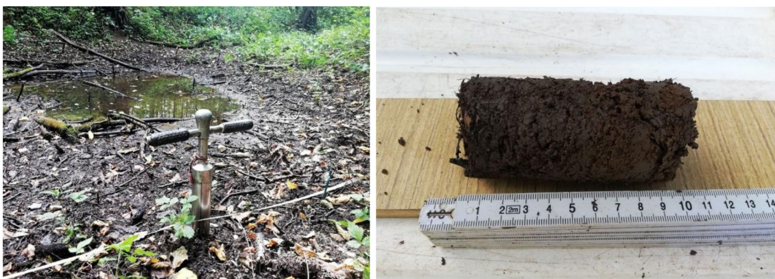
Obrázek 11. Pedologická sonda pro odběr sedimentů (lokalita č. 4), vpravo vzorek sedimentu před rozdělením na hloubkové podvzorky (© Lucie Fišarová)
