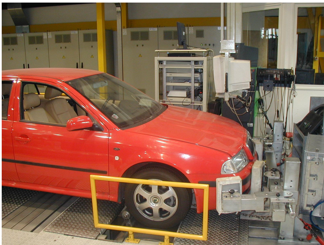
Obr. 35 – Škoda Octavia Combi s pohonem přední nápravy připravená k měření
