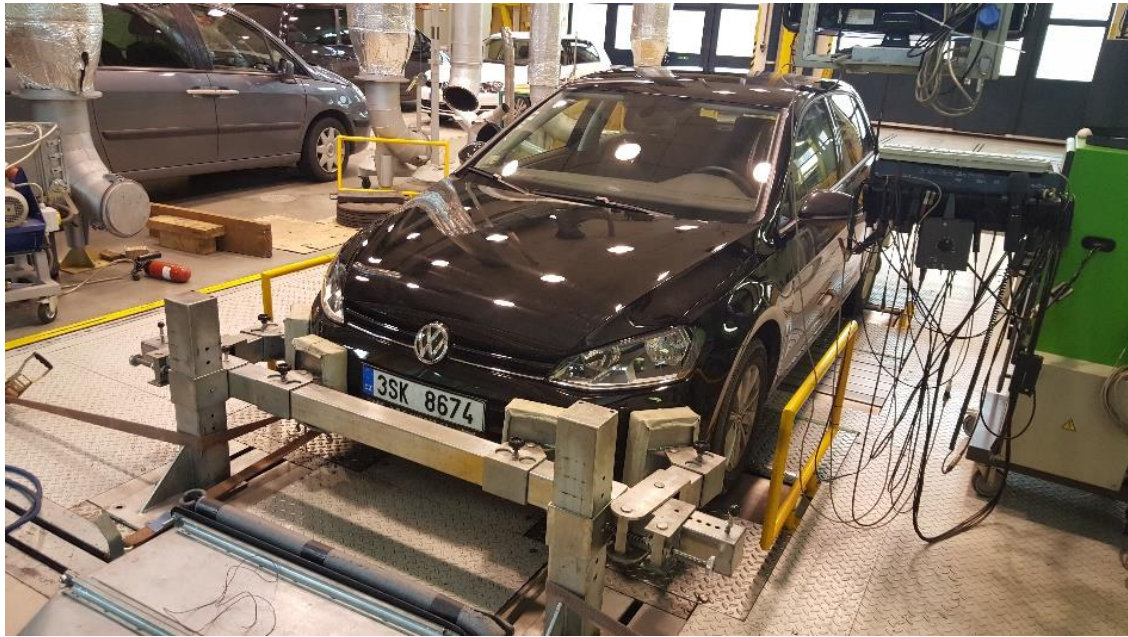
Obr. 36 – Zabezpečení vozidla proti ujetí z válců zkušebny
