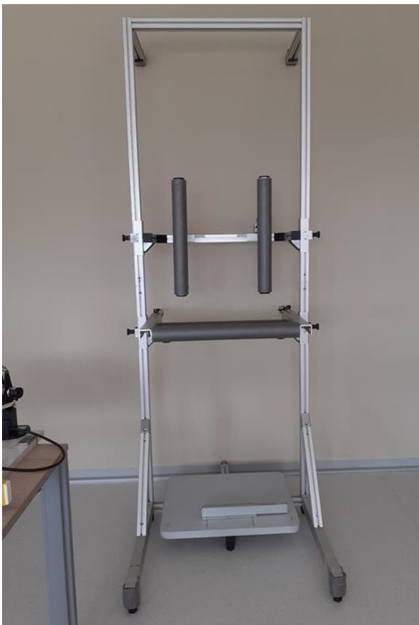
Obrázek 2. Fixační rám s pánevní a ramenní oporou
