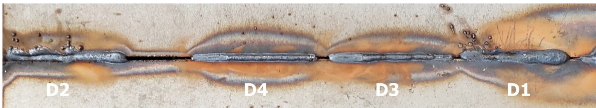
Obr. 35 VZORKY D – KOREŇOVA VRSTVA ZVARU
