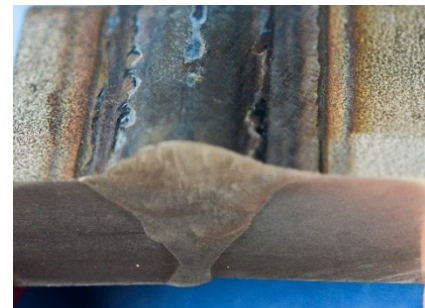
Obr. 49 Rez a povrchová vrstva zvaru D2
