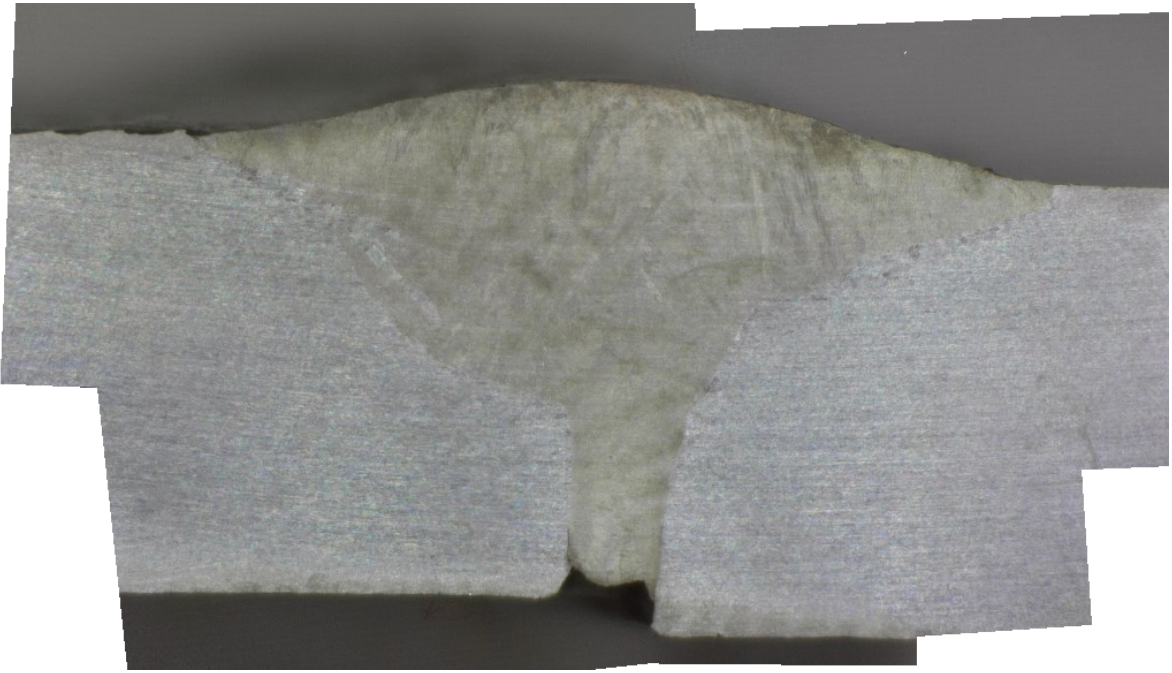
Priloha 2 metalograficky vybrus pod miroskopom 1x zvačšenie pre vzor C3
