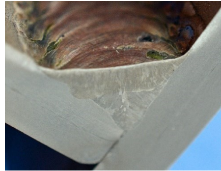
Obr. 40 Rez a povrchová vrstva zvaru B4
