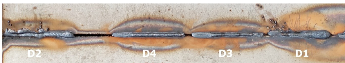
Obr. 35 VZORKY D – KOREŇOVA VRSTVA ZVARU
