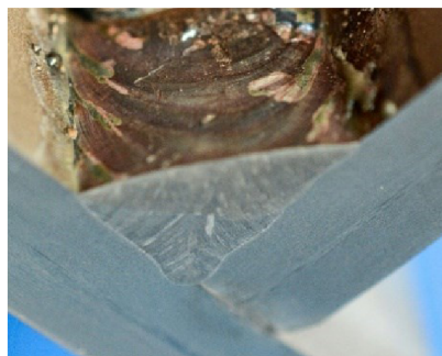
Obr. 37 Rez a povrchová vrstva zvaru B1
