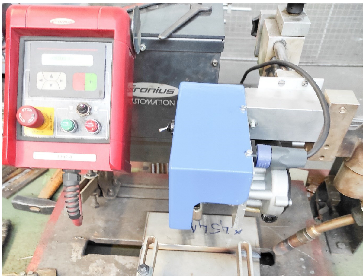
Obr. 27 Zostava zvarovacieho vzorku a lineárneho podvozku s oscilátorom
