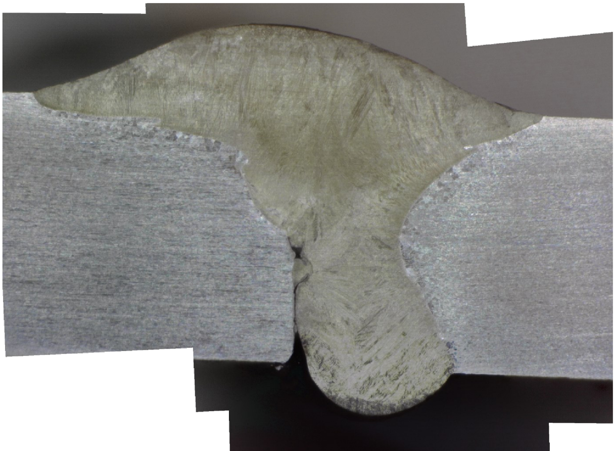
Priloha 3 metalograficky vybrus pod miroskopom 1x zvačšenie pre vzor C1
