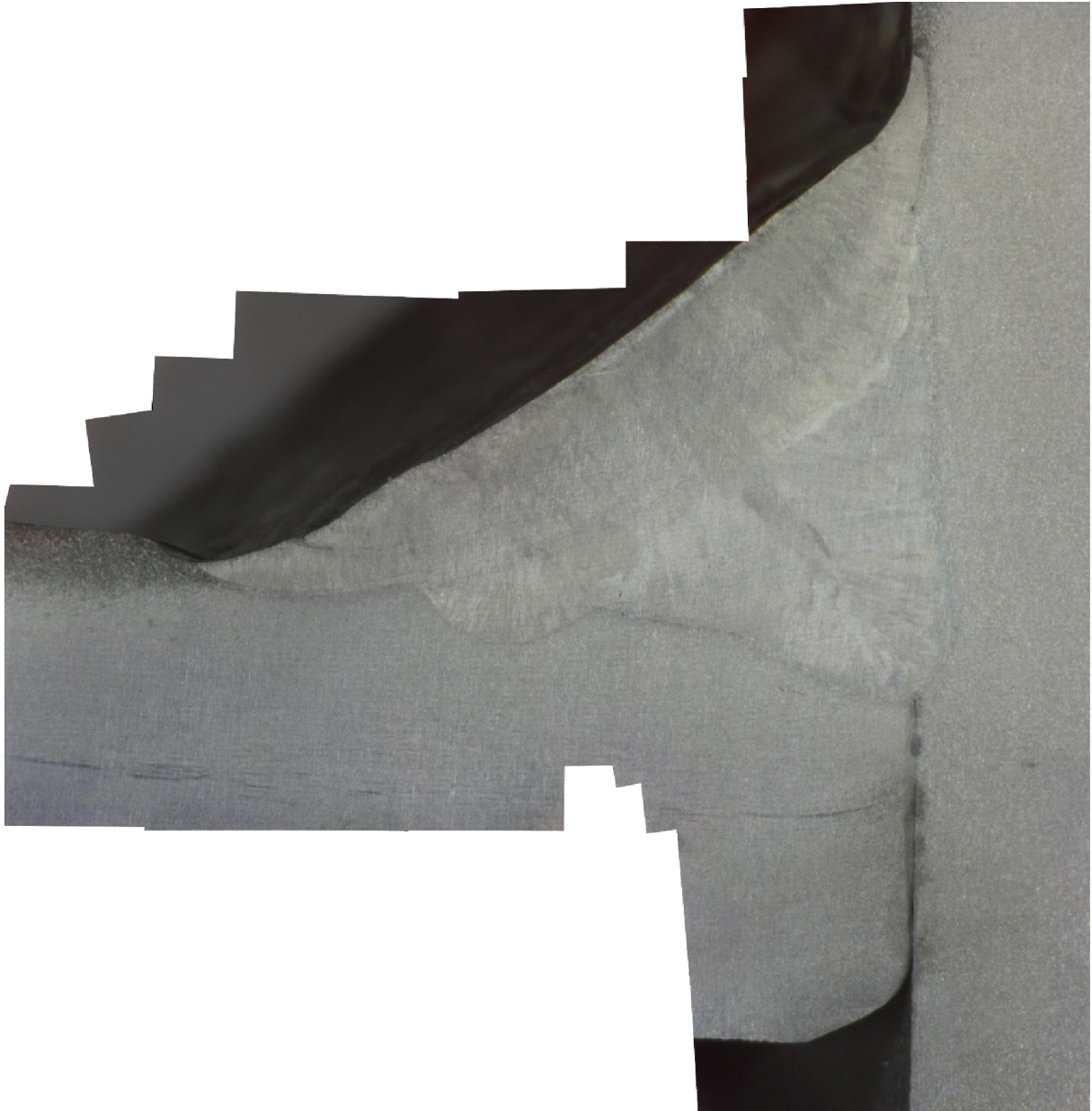
Priloha 4 metalograficky vybrus pod miroskopom 1x zvačšenie pre vzor B4
