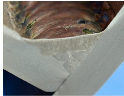
Obr. 40 Rez a povrchová vrstva zvaru B4
