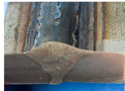
Obr. 49 Rez a povrchová vrstva zvaru D2
