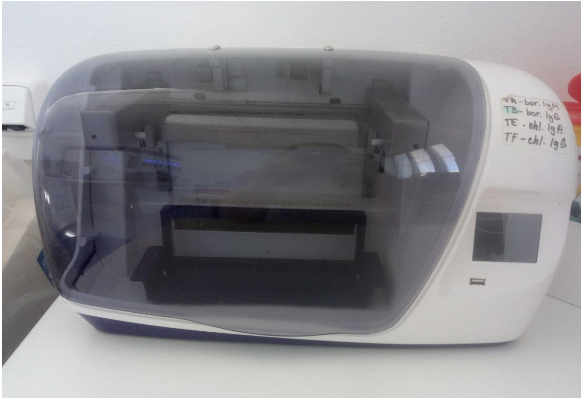
Obrázek 6: Příklad přístroje BlueDiver pro metodu Western blot používaný v laboratoři Stafila k. s. (Zdroj: Vlastní)
