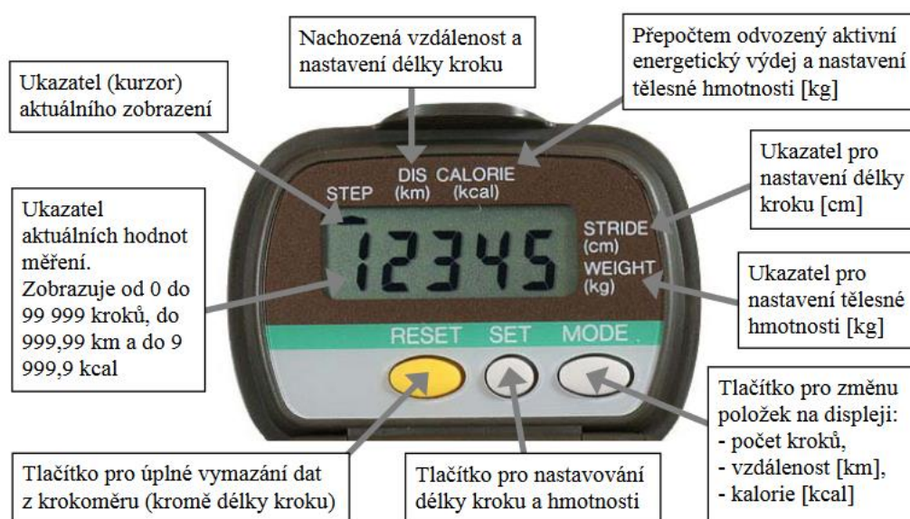
Obrázek 3 Displej krokomeřu Yamax Digiwalker SW-700 s popisem ovládacích prvků
