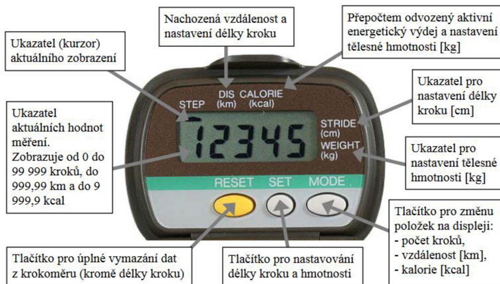
Obrázek 3 Displej krokoměru Yamax Digiwalker SW-700 s popisem ovládacích prvků
