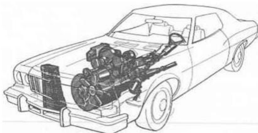
Obrázek 2: SE jako pohonná jednotka ve Fordu Torino 1973 [4]
