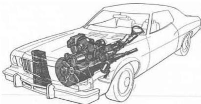
Obrázek 2: SE jako pohonná jednotka ve Fordu Torino 1973 [4]
