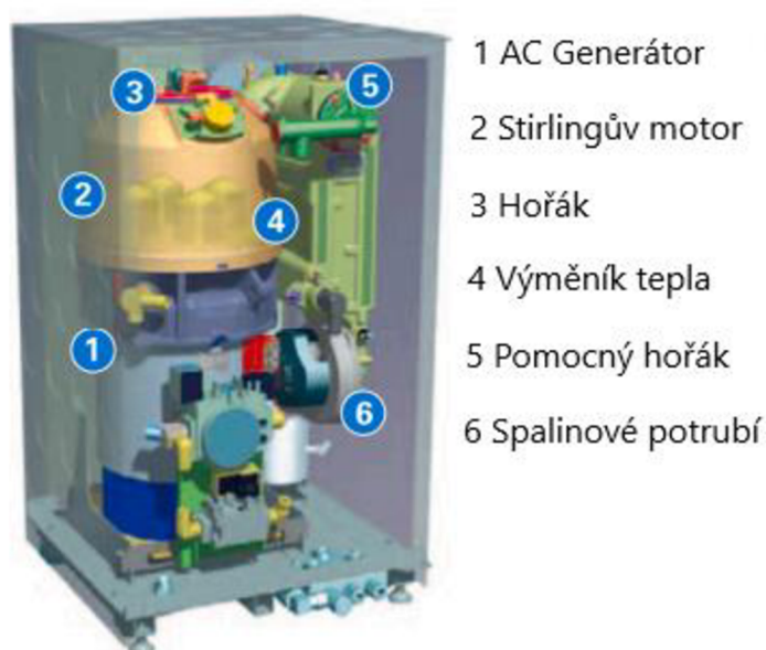
Obrázek 17: Motor Whispergen (upraveno) [5]
