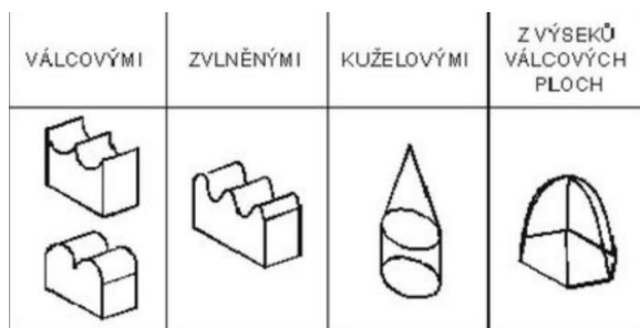
Obr. 17: Šikmé střešní plochy
