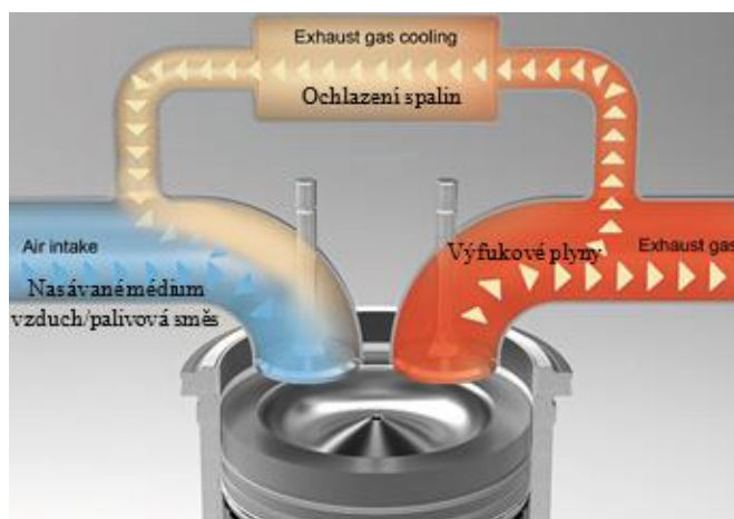
Obr. 32 Zpětné vedení výfukových plynů (upraveno) [59]
