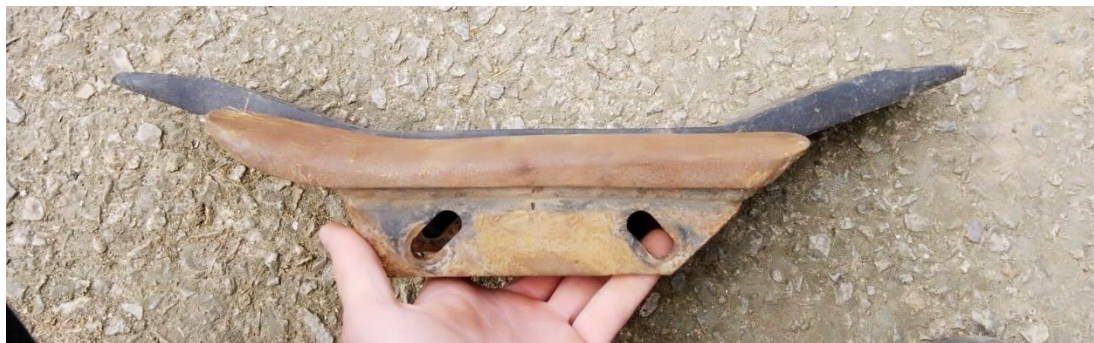
Obrázek č. 21 – Porovnání nového a opotřebovaného dláta z dlátového pluhu Maschio
