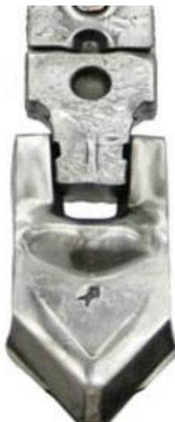
Obrázek č. 6 – Pracovní orgán výměnného systému Knock-on, zdroj:
